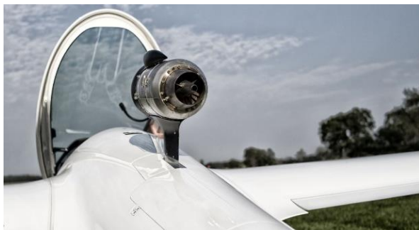
Abb. 2: Die Turbine TJ42 von M&D Flugzeugbau dient als Range-Extender von Segelflugzeugen. Die Kasaero GmbH war hier tatkräftig bei der Zulassung beteiligt.
