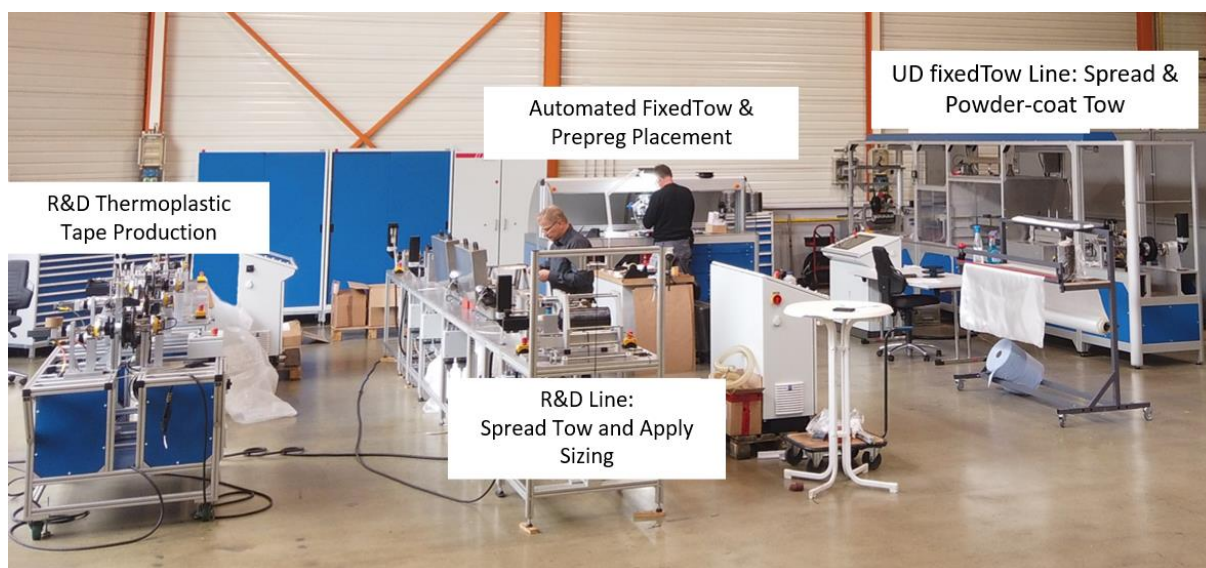
Abb. Modulare Anlage zur Faserverarbeitung für CFK
