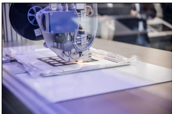
Preform gelegt mit der CROSSLAYER per Dry Fiber
