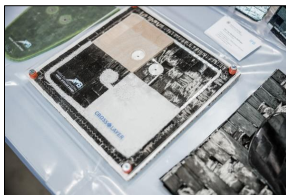
Aufbau des Skateboards: Balsa Holzkern, Glaslege, Carbon Thin ply preforms, lokales Besticken für Inserts
