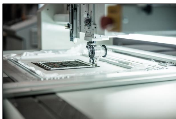
Lokale Preform Verstärkung mittels TFP
