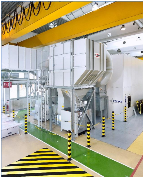
Abb. 4: Eine Entstaubungsanlage von Keller Lufttechnik für eine Portalfräsmaschine (im Hintergrund), die der Herstellung von Flugzeug-Landeklappen aus carbonfaserverstärktem Kunststoff (CFK) dient.
