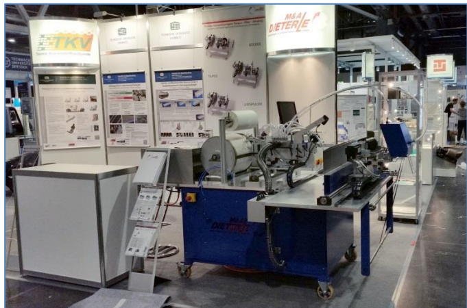
Abb. 6: Kompaktes Anlagenkonzept mit vielen Freiheitsgraden - unidirektionale textile Prepress sind individuell und bedarfsgerecht herstellbar.
